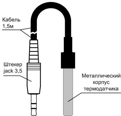
Рис.6 Термодатчик «DS18B20 L=1,5м, jack 3,5 мм». Общий вид
