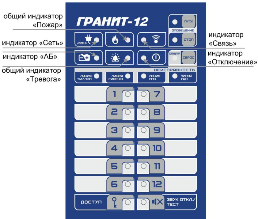
Рис.2 Панель индикации и управления прибора Гранит-12А GSM
